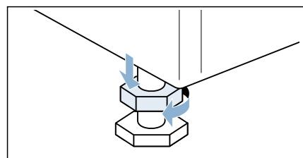
2. 转动底脚可以调节高度，以达到水平（如果条件允许可以使用水平仪）。如有需要，再进行调整。
