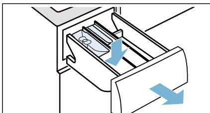
2. 将液体洗涤剂倒入专用盒。用量请严格按照洗涤剂制造商使用说明, 不能超过专用盒的最大刻度。
