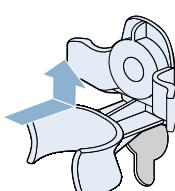
a) 将水管在固定架中夹紧。
