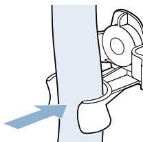
b) 将电源线在固定架中夹紧。
