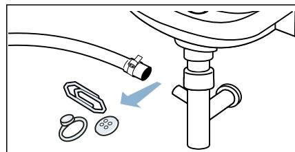
4. 重新插接排水管，用软管卡圈固定排水管的连接处。
