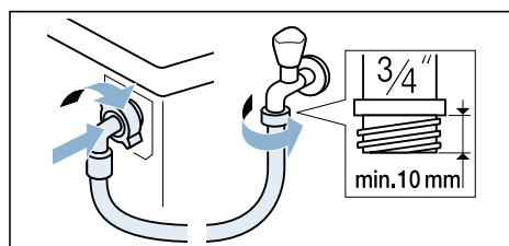
**提示：**小心地打开水龙头，并且检查连接处是否有渗漏的现象。螺纹连接处承受着与水管中相同的压力。
