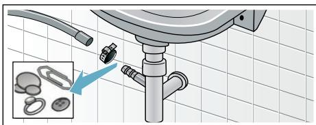
4. 重新插接排水管，用软管卡圈固定排水管的连接处。
