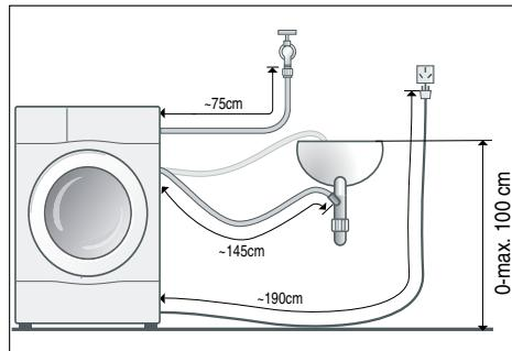
**提示：**在使用水管架的情况下，可用的水管 / 电源线长度会降低。
