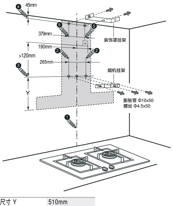
提示：尺寸Y的下沿是油烟机的最低点（不包含油杯）。
