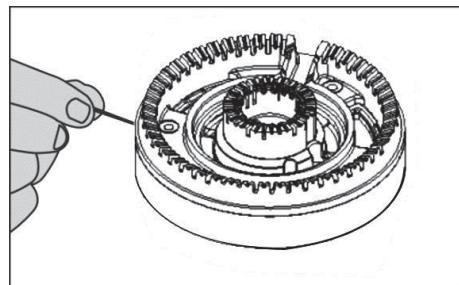
请勿用水直接冲洗火槽，再次使用前务必确保火盖干燥。
