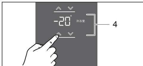
温度设定值即使在断电之后也无需重新设定。
