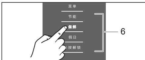
进入保鲜模式后,冷藏室显示 2°C,变温室显示 0°C,冷冻室仍保持在原来的温度设置下运行。
