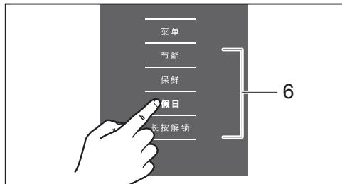
进入假日模式后,冷藏室显示 14°C,变温室显示 4°C,冷冻室仍保持在原来的温度设置下运行。
