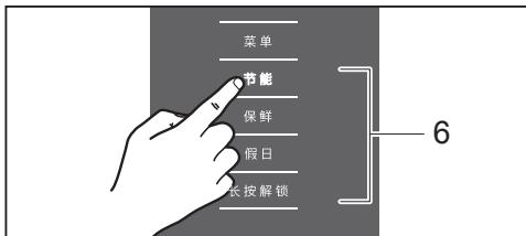
进入节能模式后,冷藏室显示 8°C,变温室显示 0°C,冷冻室显示 -16°C,制冷系统将自动在这样的温度设置下运行。
