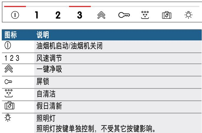
**提示：**请触摸以上图标进行吸油烟机的操作。
