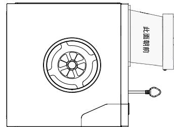
然后在油烟机上用螺钉固定密封垫和烟管基座，注意烟管基座上的文字提示。
