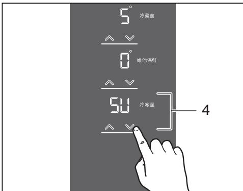
在速冻食品前应提前打开速冻功能几个小时,让冷冻室降至较低温度,再放入食品。通常 4—6 小时即可,若一次性冷冻大量食品,应提前打开速冻功能 24 小时。如速冻较少食品(大约 2 公斤),可不用提前打开速冻功能。
